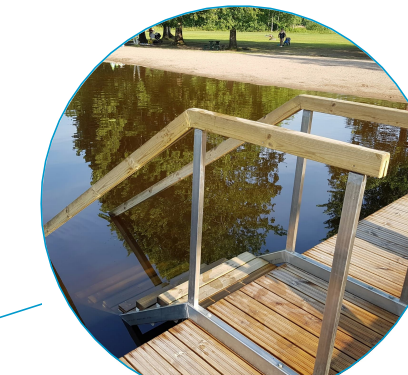
2 kpl Uimaportaat leveä Leveys 1 m, askelmat kotimaista kestopuuta 48x98 mm. Kallivuus -45 astetta (helppokulkurungon) Kestopuu käsiöhdie. Runko haponesatavää terästä
